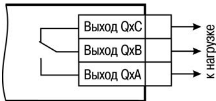
Рисунок 6.1 - Схема подключения нагрузки к ВЭ типа Р
