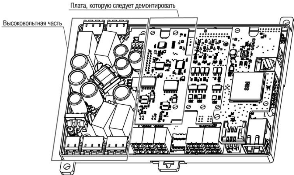
Рисунок Д.6 – Расположение зоны с высоковольтной частью и платой, закрывающей доступ к джамперу XP6
